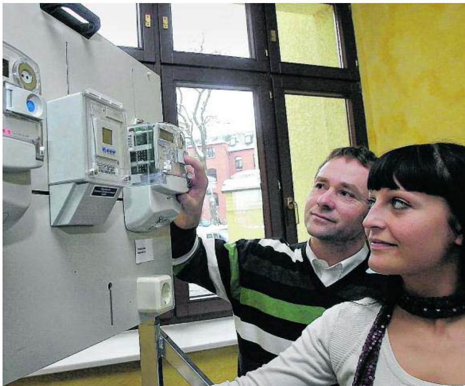
Die neue Zählergeneration soll bis zum Jahr 2022 den klassischen Drehstromzähler ersetzen. vielerorts sind die digitalen Gerte schon im Einsatz, meist jedoch nur zu Testzwecken. FOTO: MARCUS RICHTER/ARCHIV
