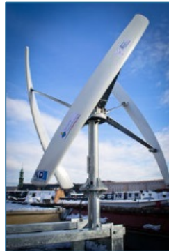
Abbildung 9-6 Kleinwindenergieanlage der Westsächsischen Hochschule Zwickau (WHZ 2013)
