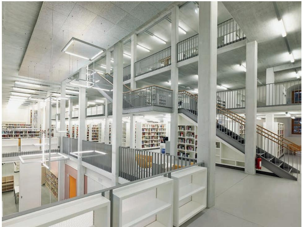
Notwendige Einbauten (Garderoben, WC, Küche, Lagerräume etc.) erfolgten im Erdgeschoss sowie im 1. und 2. Obergeschoss westlich des Haupttrep- penhauses als eingestellte Boxen, die optisch von Außen- und Innenwänden und von den Geschoss- decken abgesetzt sind.
