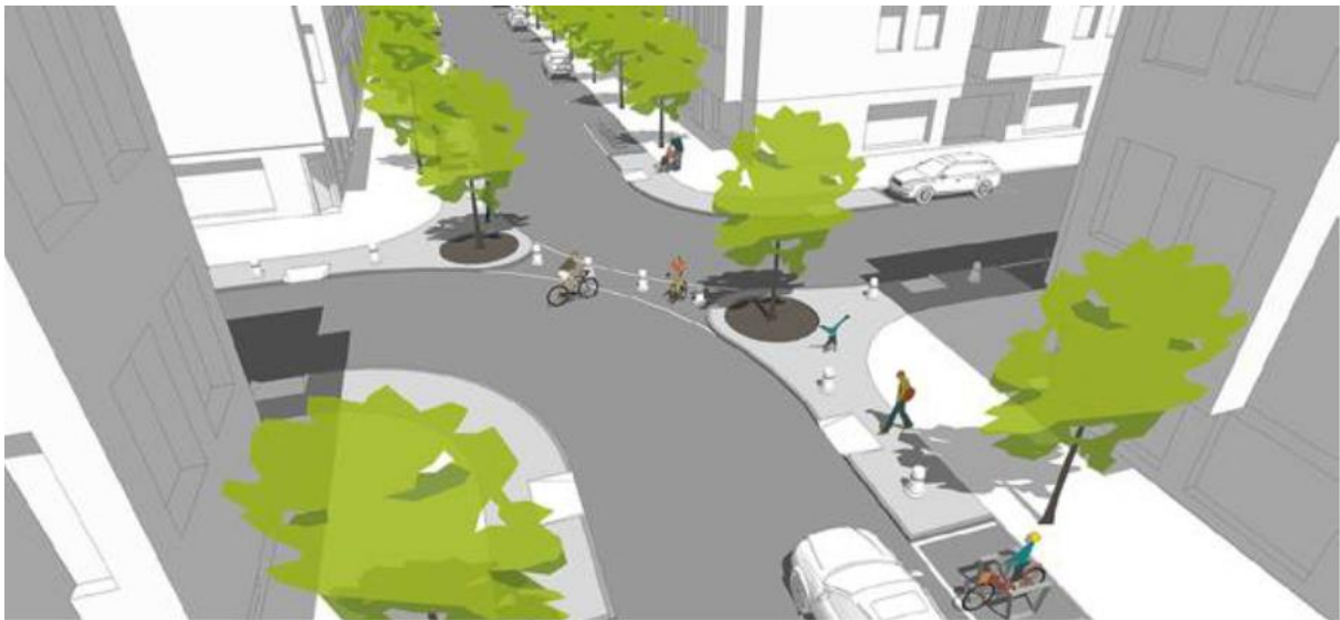
Abbildung 26: Schemadarstellung einer Diagonalsperre. Quelle: ADFC
