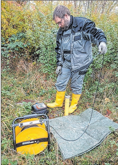
INKLINOMETERMESSUNG AM 17.11.2020 AM EHEMALIGEN FAHRÜBUNGSPLATZ
