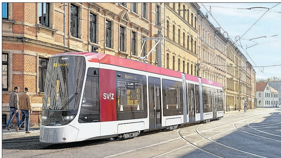
DIE NEUEN FAHRZEUGE WERDEN RUND 30 METER LANG UND 2,30 METER BREIT SEIN SOWIE AUF METERSPURIGEN NETZEN EINGESATZT. SIE SIND VOLLSTÄNDIG BARRIEREFREI KONZIPIERT UND SOLLEN DEN ÖFFENTLICHEN NAHVERKEHR IN BEIDEN STÄDTEN GRUNDLEGENDE MODERNISIEREN. FOTOMONTAGE: STADLER RAIL AG/NOSE AG
