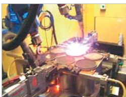
Schweißroboter in der LKW-Fertigung
