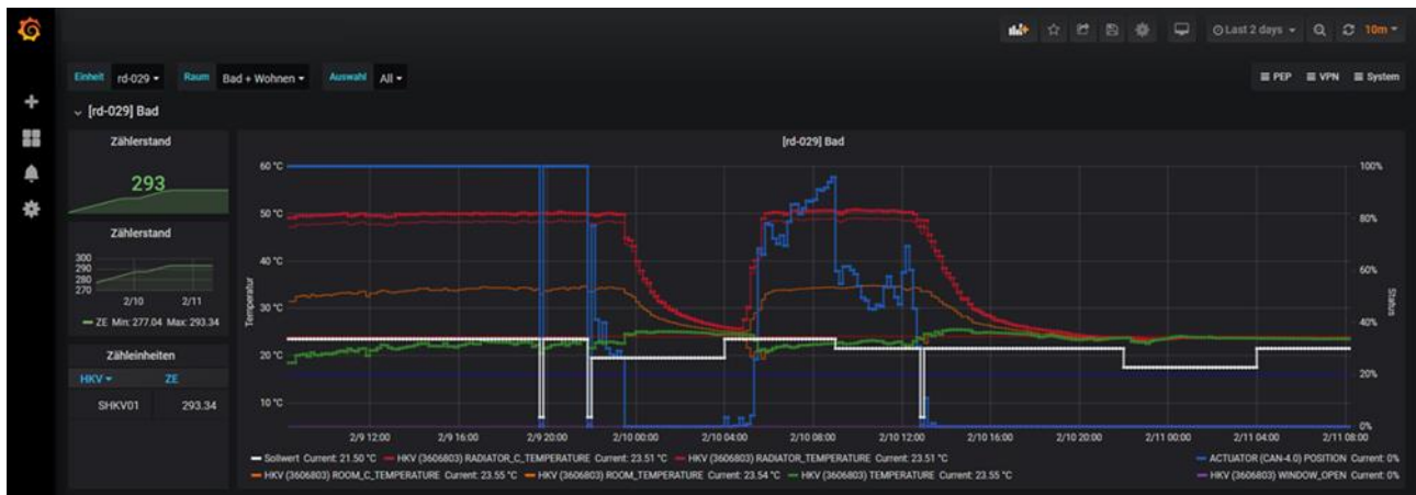
Abbildung 47 Übersicht Temperaturen, Stellanforderungen und Zählerstände im Kairos System
